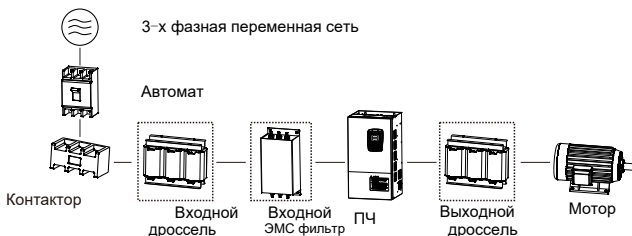
Рисунок 7-1 Схема установки внешних ЭМС-компонентов
